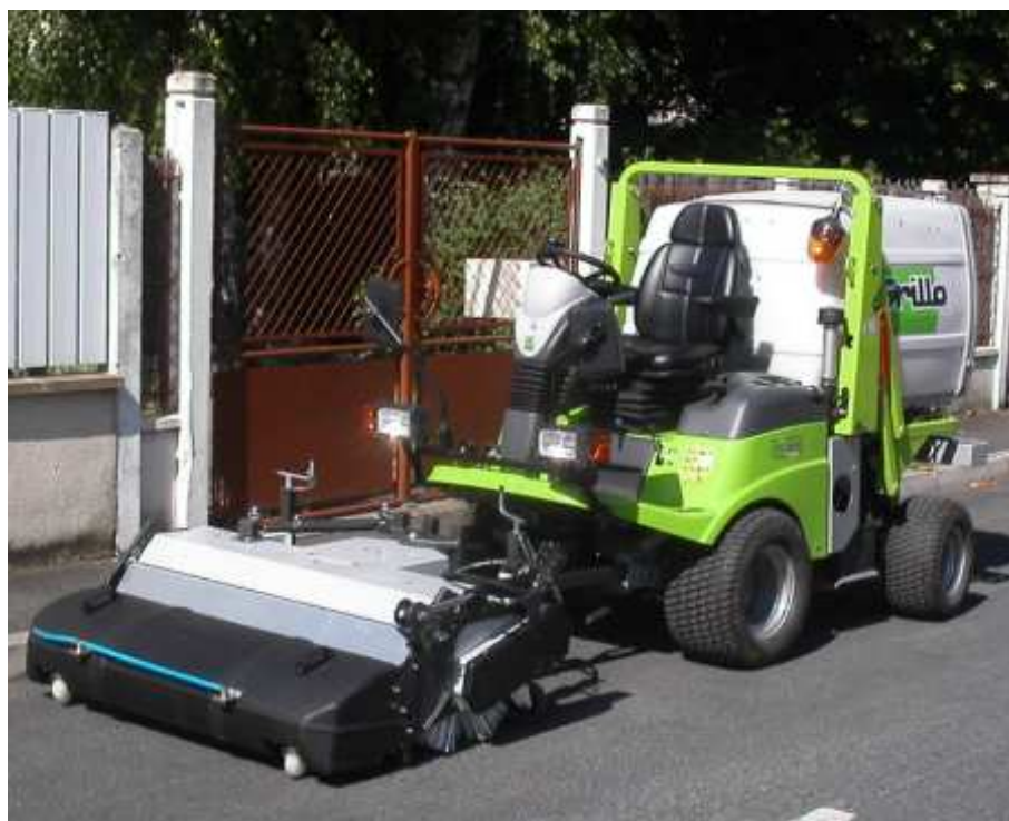
Rampe de pulvérisation avec cuve de 100 litres d'eau
