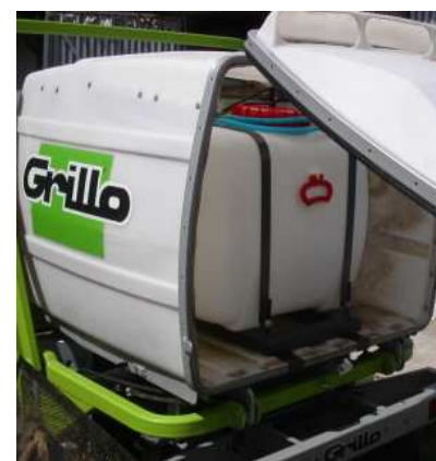
Rampe de pulvérisation avec cuve de 100 litres d'eau
