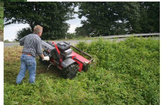
Roues cages avec disques anti-glisse pour le travail en fortes pentes
