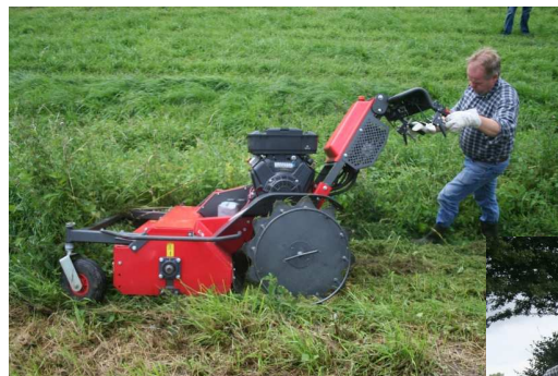
Roues cages avec disques anti-glisse pour le travail en fortes pentes
