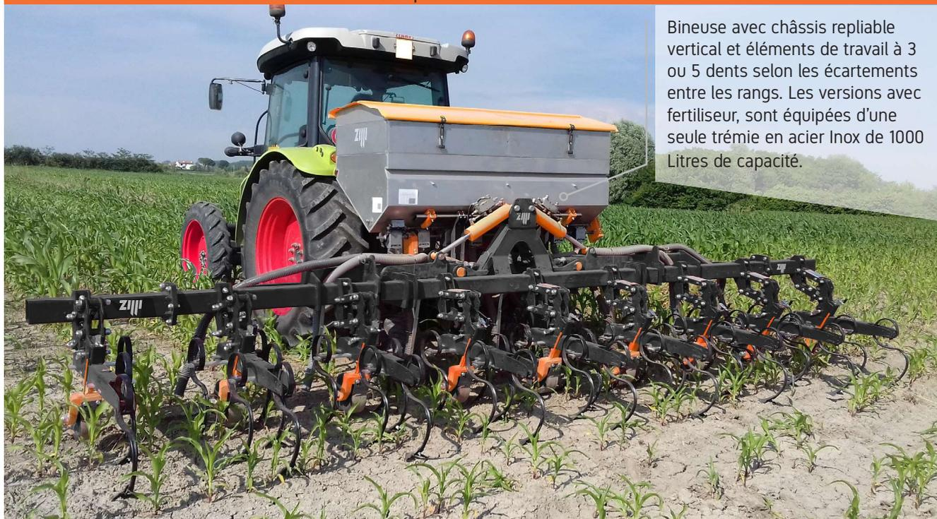
Bineuse avec châssis repliable vertical et éléments de travail à 3 ou 5 dents selon les écartements entre les rangs. Les versions avec fertiliseur, sont équipées d'une seule trémie en acier Inox de 1000 Litres de capacité.
