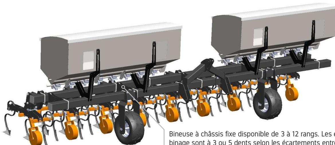
Bineuse à châssis fixe disponible de 3 à 12 rangs. Les éléments de binage sont à 3 ou 5 dents selon les écartements entre les rangs. Les versions avec fertiliseur sont équipées d'une seule trémie en acier inox de 700, 1000 ou 2000 litres de capacité.
