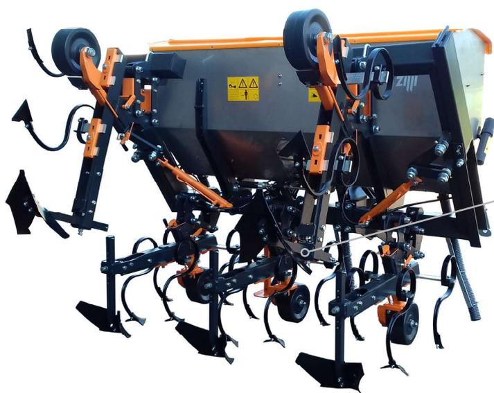
Bineuse avec éléments de travail à 3 ou 5 dents, selon les écartements entre les rangs. Les versions avec fertiliseur, sont équipées d'une seule trémie en acier Inox de 400 Litres de capacité. Les éléments de travail extérieurs, sont à repliage hydraulique.
