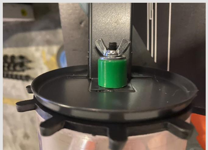
Système de changement rapide du disque distributeur permettant une adaptation au type de graines semées à chaque pression de la poignée.
