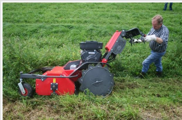
Roues cages avec disques anti-glisce pour le travail en pentes
