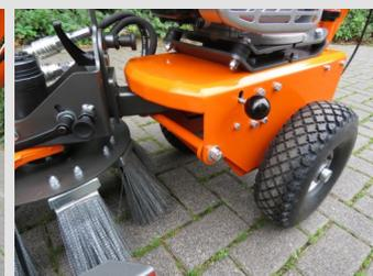
Réglage de la hauteur du châssis pour compenser l'usure de la brosse
